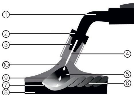
Рис. 23. Полуавтоматическая сварка MIG/MAG.
